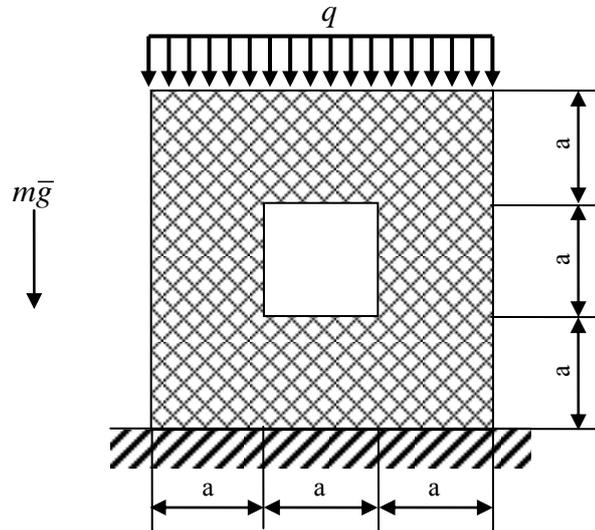
Кроме распределённой нагрузки  $q$  на тело действует сила тяжести и начальное деформированное состояние вследствие разницы температуры тела и окружающей среды равной  $\Delta T$ .
